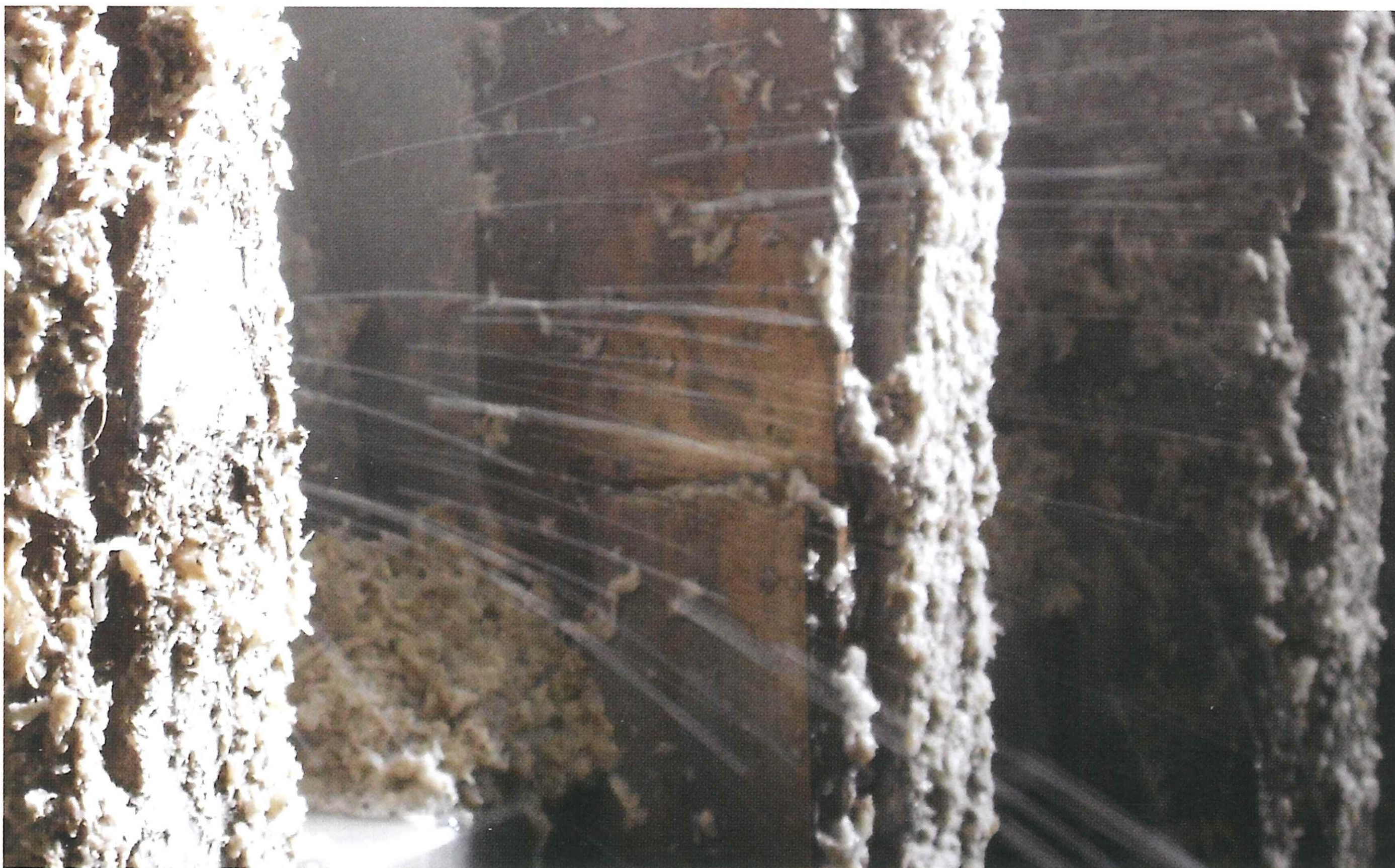
Рис. 5. Струи жидкости в моноблочных перфорированных листах (типа А) вследствие открытия отверстий, в которые забилась пульпа
