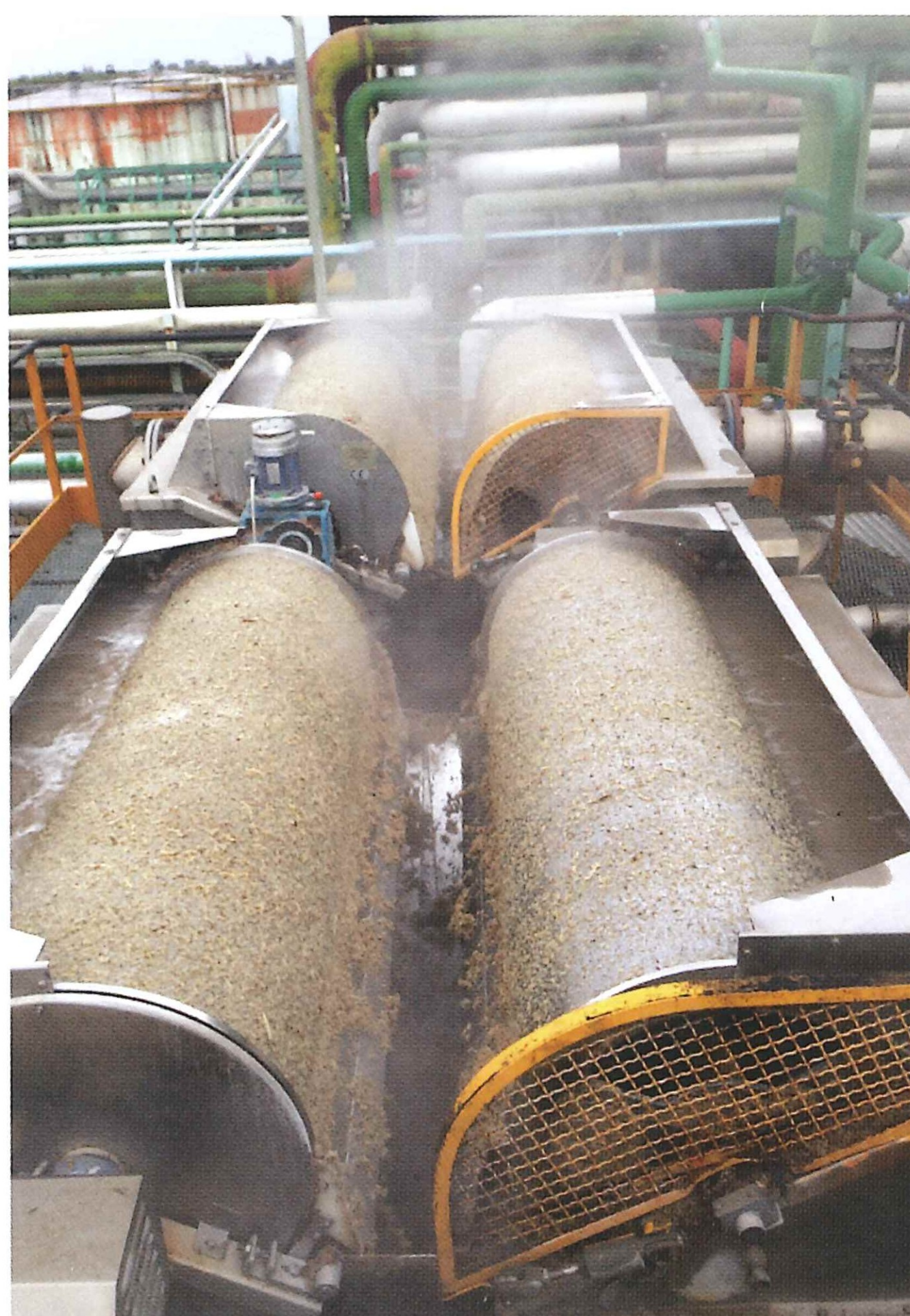
Рис. 9. Фильтры для отделения пульпы от жомпрессовой воды
