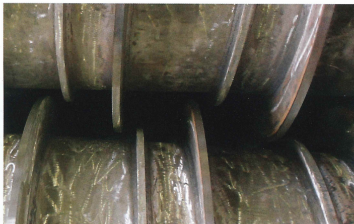
Fig. 4: Doppia Elica (Brevetto Babbini) / Second flight (Babbini patent)
